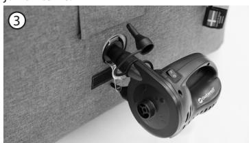
Une fois le gonflage totalement effectué, fermez la valve d'étanchéité en enfoncez la buse de la pompe. Cela scellera le bouchon interne et empêchera l'air de s'échapper pendant la fermeture du bouchon.
