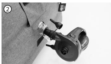
Na pumpu nasadte nafukovací hubici. Zasuňte hubici a zapněte pumpu.
